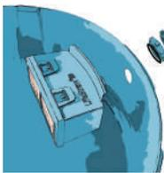
Coloque las piezas del sistema de autollenado en el orificio de el depósito de agua prefiltrada y conecte la manguera al orificio de entrada de agua del tanque y posteriormente el otro extremo a la llave de salida de la toma de agua.
