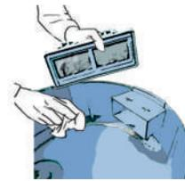
Retire la malla de la caja de auto-llenado todos los días y lave únicamente con agua por ambos lados para retirar los residuos acumulados.
