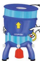
Quite el seguro que fija el depósito para agua purificada con el depósito para agua prefiltrada y levante este último hacia arriba
