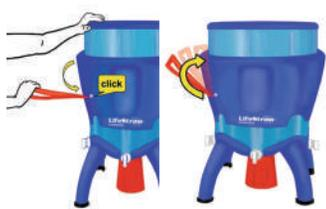
Verifique que el depósito de agua prefiltrada contenga por lo menos un poco de agua, después jale hacia abajo la palanca de retrolavado con cuidado hasta que tope sin forzar y suéltela. La palanca sola regresará a su posición inicial
