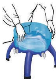
Lave con jabón y agua purificada el depósito para agua purificada, enjuague perfectamente y coloque nuevamente el depósito para agua prefiltrada. (hasta que haga click) Nunca deje destapado por mucho tiempo el depósito de agua purificada
