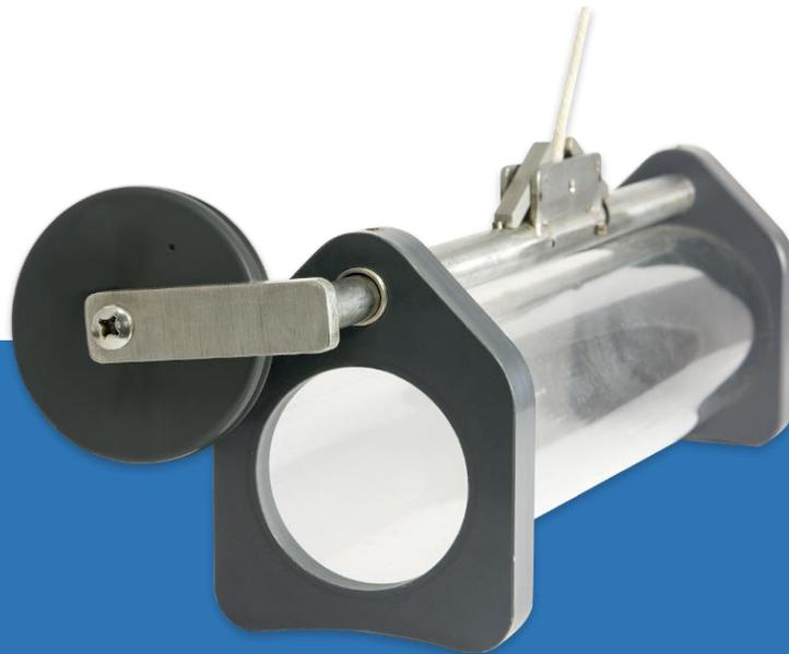
El **Muestreador de Agua (Botella) Horizontal, LaMotte, Código 1087**, de nuevo diseño permite tomar muestras de agua a profundidades específicas. Se incluye una línea calibrada de 20 metros, marcada a intervalos de un metro permitiendo tomar muestras de agua a profundidades específicas. El tubo de acrílico transparente permite una inspección visual de la muestra antes de dispensarla y contiene aproximadamente 1200 ml de muestra.
