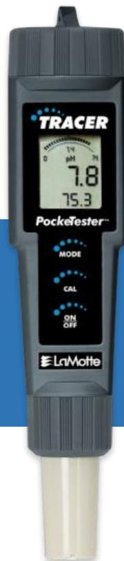
El medidor electrónico de pH TRACER PockeTester™ permite la lectura directa del pH desde 0,01 hasta 14,00 pH. El TRACER ofrece visualización simultánea de pH y temperatura y una memoria para 15 lecturas. El rango de pH es de 0,00 a 14,00 pH/0,01 pH. El rango de temperatura es de 23° a 194°F (5° a 90° C). Es un dispositivo portátil diseñado para medir el pH de soluciones acuosas con alta precisión. Ideal para aplicaciones en laboratorios, piscinas, acuarios y procesos industriales.
