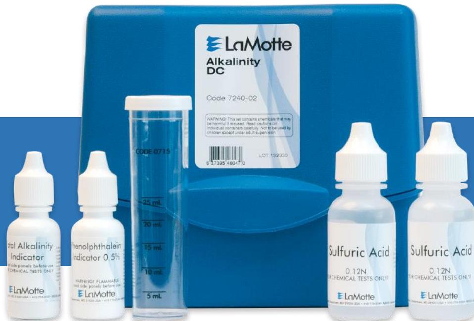
El Kit de Prueba de Alcalinidad en Agua, con el código 7240-02, es una herramienta fundamental para medir la alcalinidad total en distintas muestras de agua. La alcalinidad es crucial para determinar la capacidad del agua para neutralizar ácidos, una característica vital en diversos procesos industriales y aplicaciones domésticas.
